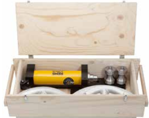
Для изготовления этажных изгибов на нескольких уровнях.
