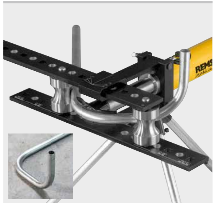
Для изготовления этажных изгибов на нескольких уровнях.
